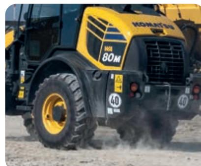
Velocità trasmissione idrostatica limitata a 40 km/h (optional)
