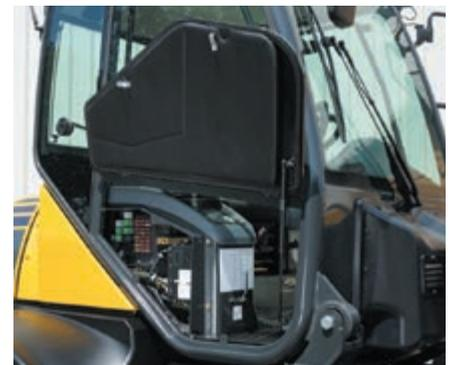
*Seitliche Wartungsklappe für schnellen Wartungszugang*
