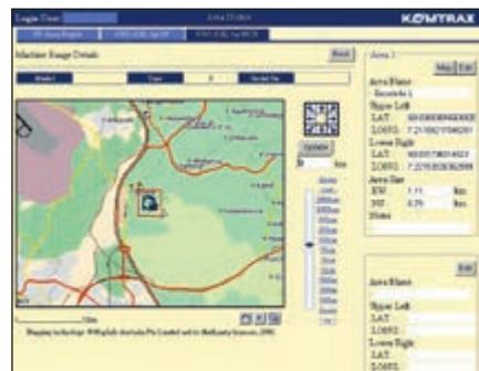
Sicurezza totale – La funzione “Blocco motore” permette di programmare quando il motore di una macchina può essere acceso. In più con “geo-fence” KOMTRAX™ ti invia un messaggio di notifica ogni volta la tua macchina entra od esce da una area operativa predefinita.
