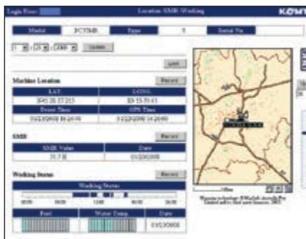
Ore di esercizio macchina – Con lo “storico giornaliero sulle ore di esercizio” puoi avere i tempi precisi di utilizzo della macchina; sia quando il motore è stato acceso e spento, sia il tempo totale di esercizio.
