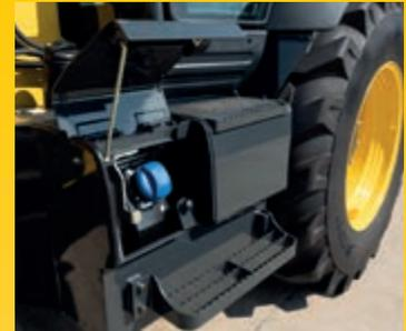
AdBlue®, Kraftstoff und Hydrauliköl können an der Seite der Maschine bequem vom Boden aus aufgefüllt werden
