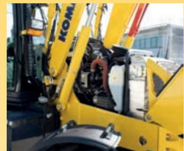
Die tägliche Wartung wird durch den Zugang zum Motorraum von beiden Seiten und die Anordnung der Wartungspunkte an der linken Seite vereinfacht
