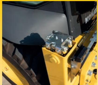
Schlauchbruchventile an Pratzen, Hubgerüst und Stiel (Standard)
