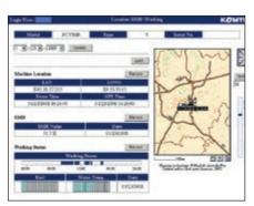
Ore di esercizio macchina – Con lo "storico giornaliero sulle ore di esercizio" puoi avere i tempi precisi di utilizzo della macchina; sia quando il tuo motore è stata acceso e spento, sia il tempo totale di esercizio.
