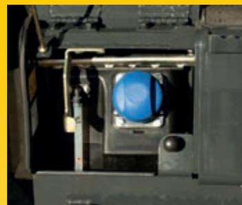
Les réservoirs d'huile hydraulique, de carburant et d'AdBlue® sont facilement accessibles sur le côté de la machine. L'appoint s'effectue au niveau du sol, pour plus de confort.
