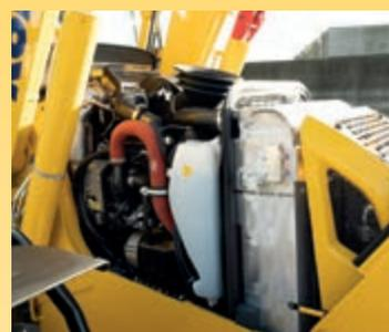
La maintenance quotidienne est aussi beaucoup plus facile grâce à l'ouverture avant à deux positions et à un point de contrôle plus accessible sur le côté gauche.
