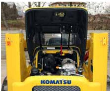
Die weit öffnende Motorhaube ermöglicht eine schnelle Motorinspektion.
