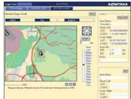
*Gesteigerte Sicherheit – Mit Hilfe der Motorsperrfunktion lässt sich festlegen, wann die Maschine gestartet werden darf. Die Geofence-Funktion benachrichtigt den Maschinenbesitzer, sobald die Maschine einen festgelegten Einsatzbereich verlässt.*
